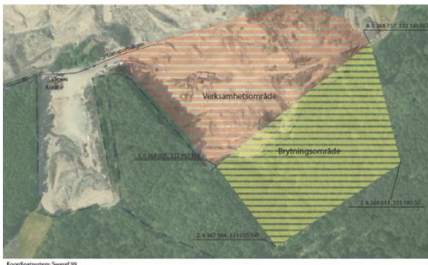
Figur 2. Planerat brytningsområde, se gul markering och täktens verksamhetsområde är markerat med orange.
